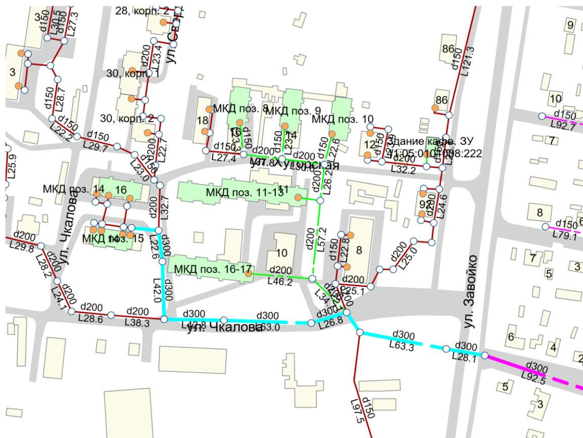
Рисунок 4.14. Строительство и реконструкция сетей водоотведения для подключения объектов МКД поз. 16-17, МКД поз. 11-13, МКД поз. 8-10 (3 шт.), МКД поз. 14-15 (2 шт.)
