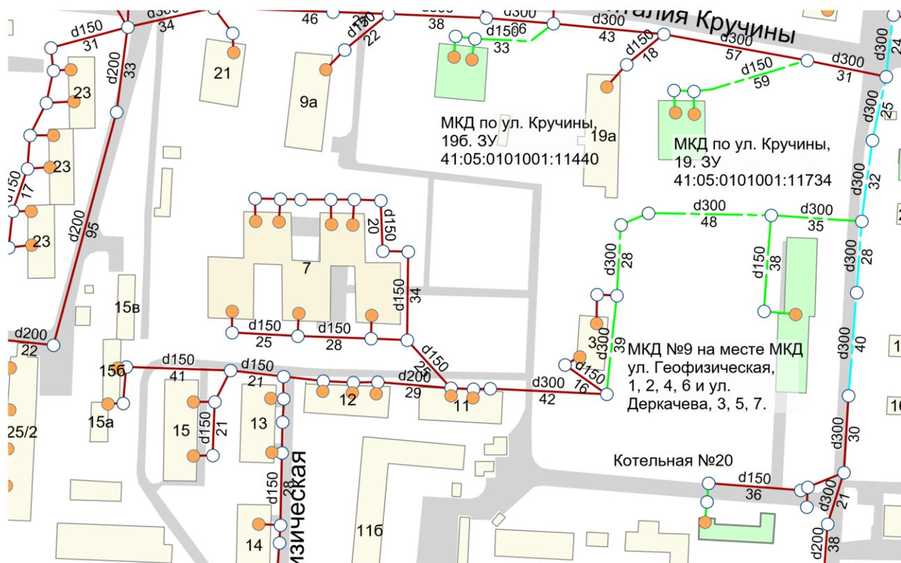
Рисунок 4.3. Строительство сетей водоотведения для подключения объектов: МКД по ул. Кручины, 196. ЗУ 41:05:0101001:11440, МКД по ул. Кручины, 19. ЗУ 41:05:0101001:11734, МКД №9 на месте МКД ул. Геофизическая, 1, 2, 4, 6 и ул. Деркачева, 3, 5, 7, а также реконструируемой котельной №20
