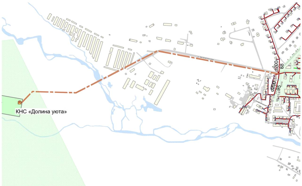
Рисунок 4.28. Строительство КНС «Долина уюта», а также напорного коллектора до камеры гашения напора по ул. В. Кручины.
