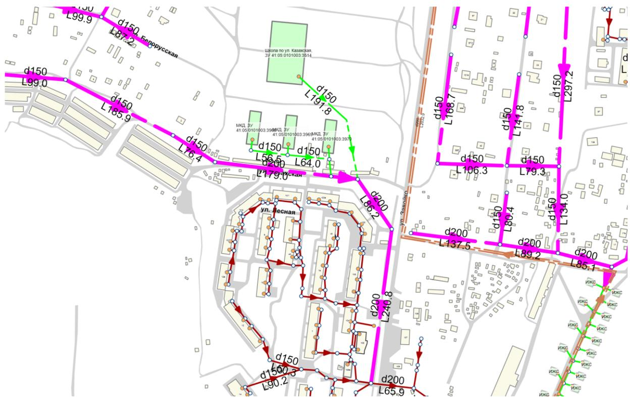
Рисунок 4.27. Строительство самотечного коллектора. Подключение к централизованной системе водоотведения перспективной застройки по ул. Казахская. Ду 200 мм, протяженность 400 м. Строительство сетей водоотведения для подключения МКД, ЗУ 41:05:0101003:3968, МКД, ЗУ 41:05:0101003:3969, МКД, ЗУ 41:05:0101003:3970, школы по ул. Казахская, ЗУ 41:05:0101003:3514
