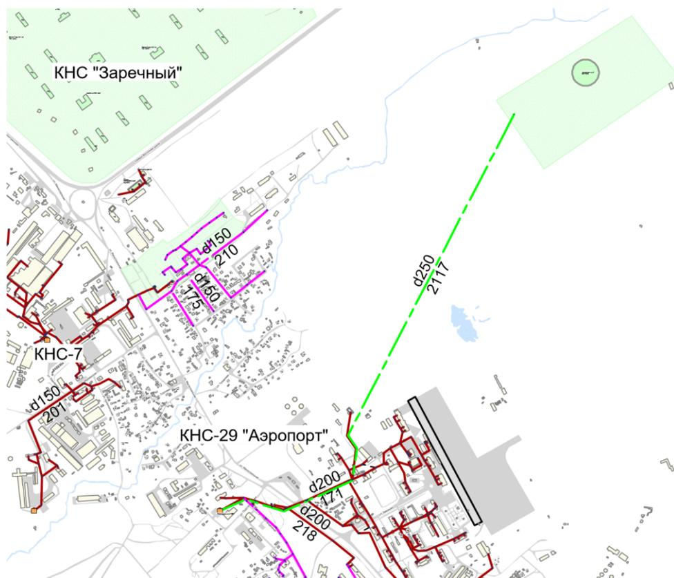
Рисунок 4.17. Строительство самотечного коллектора для проектируемого аэровокзального комплекса аэропорта г. Петропавловск-Камчатский
