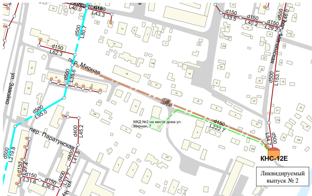
Рисунок 4.31. Расположение напорного коллектора и КНС-12Е в модели
