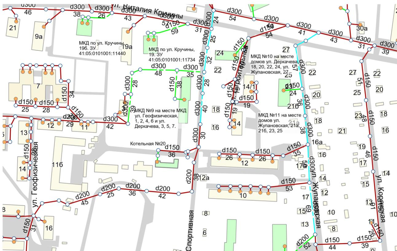
Рисунок 4.2. Реконструкция сетей водоотведения района ул. Геофизическая, Спортивная, Строительная, Деркачева с увеличением диаметра до Ду 300 мм
