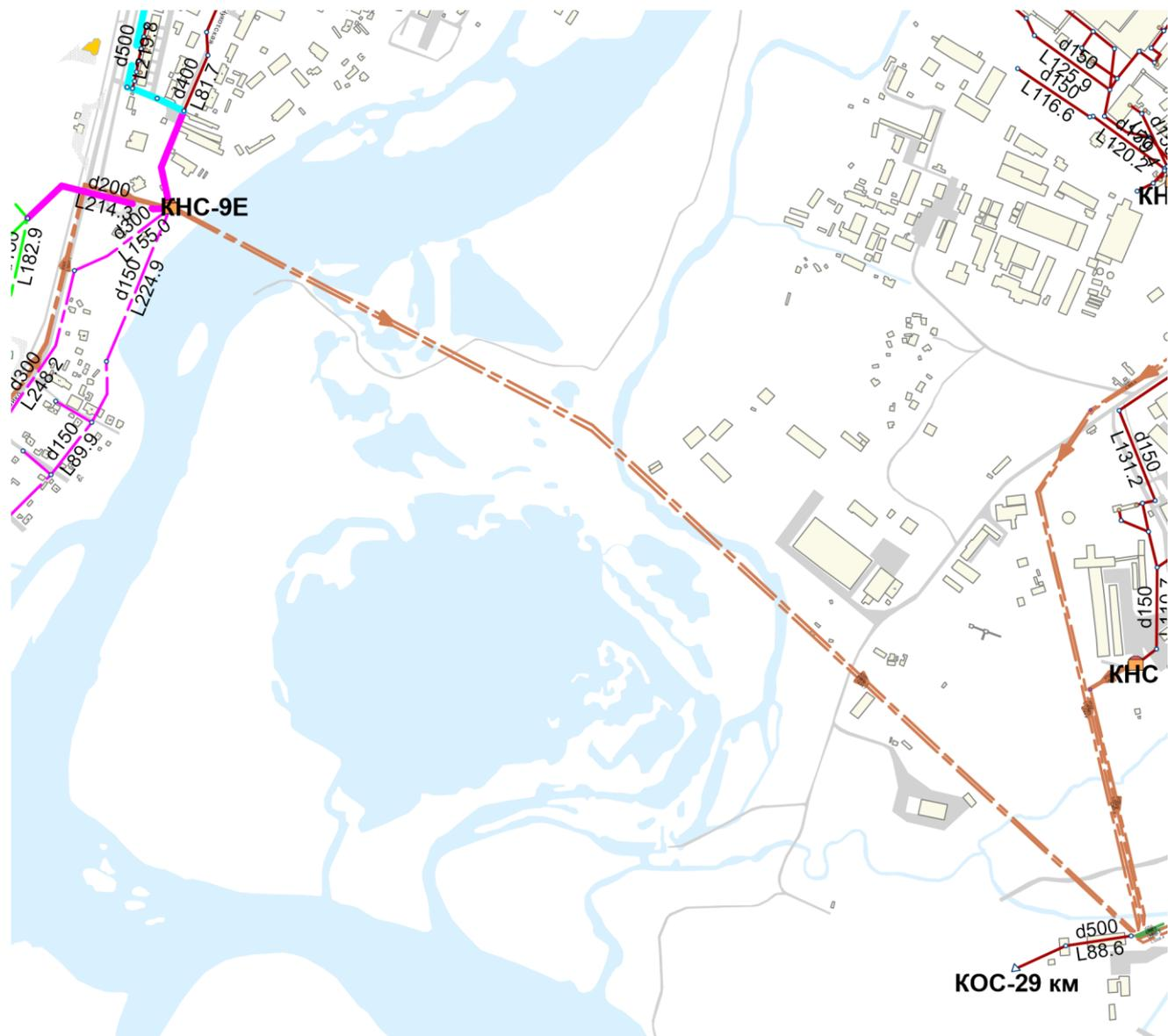
Рисунок 4.34. Расположение КНС-9Е и напорных коллекторов в модели
