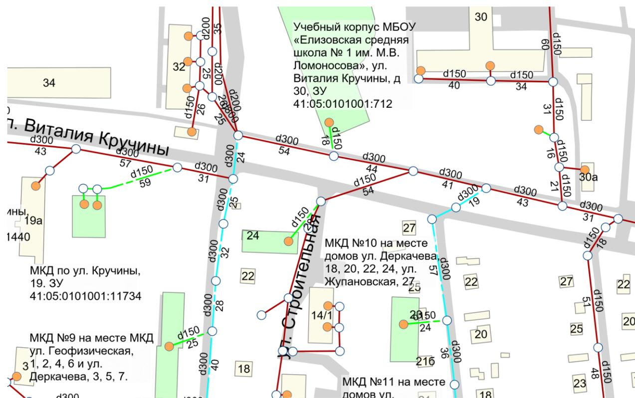
Рисунок 4.4. Строительство сетей водоотведения для подключения МКД №10 на месте домов ул. Деркачева, 18, 20, 22, 24, ул. Жупановская, 27, МКД №11 на месте домов ул. Жупановская, 21а, 21б, 23, 25, а также учебного корпуса МБОУ «Елизовская средняя школа № 1 им. М.В. Ломоносова», ул. Виталия Кручины, д. 30
