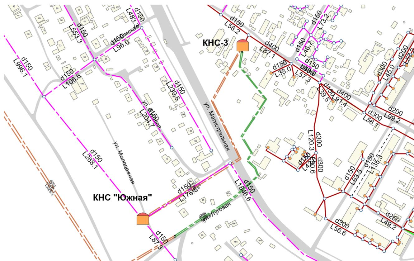
Рисунок 4.37. Расположение КНС «Южная» и напорных коллекторов в модели
