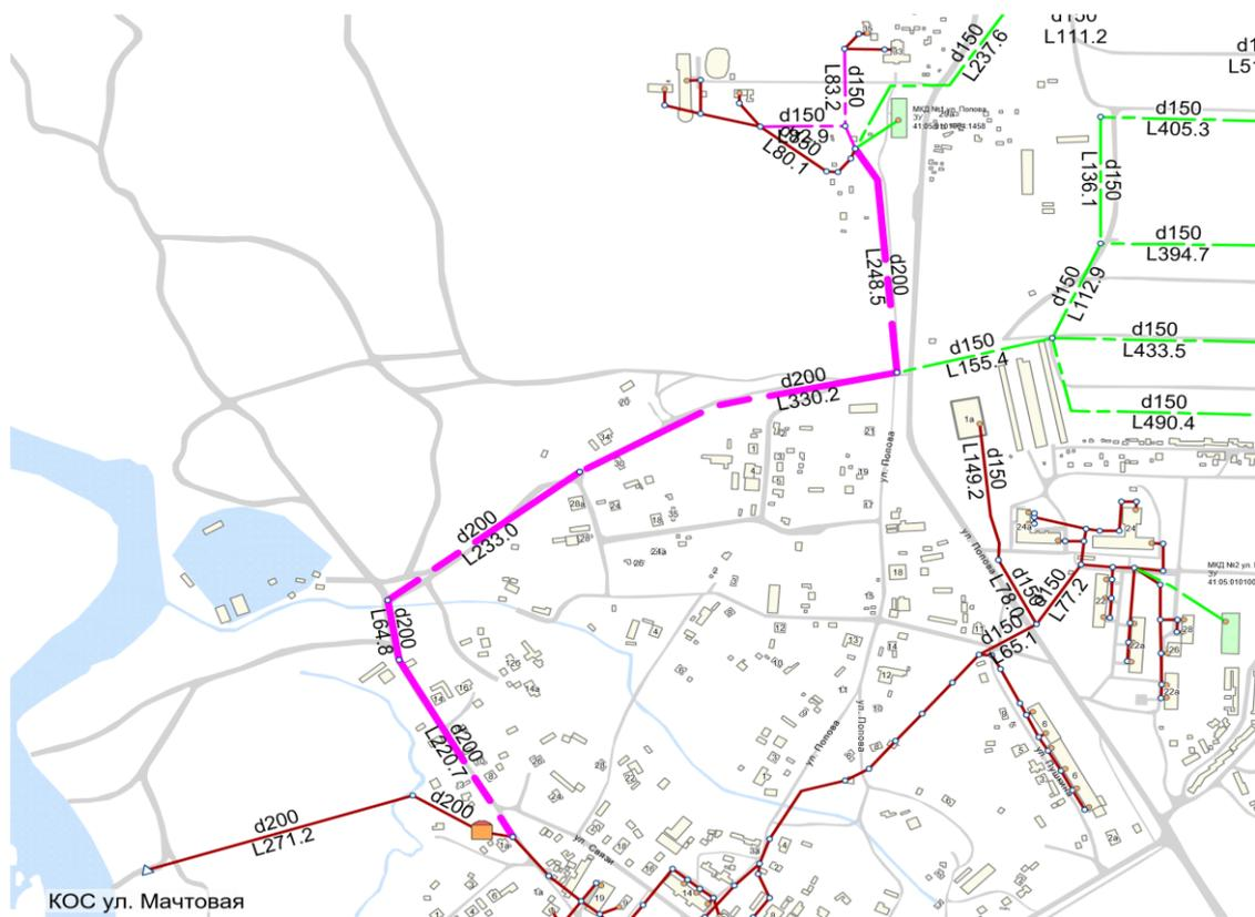
Рисунок 4.21. Строительство самотечного коллектора для подключения к централизованной системе водоотведения перспективной застройки по ул. Винокурова, ул. Осенняя, ул. Тверская, ул. Поротова, ул. Симакова, ул. Маяковского, ул. Мачтовая, ул. Попова, ул. Связи. Ду 200 мм, протяженность 1290 м
