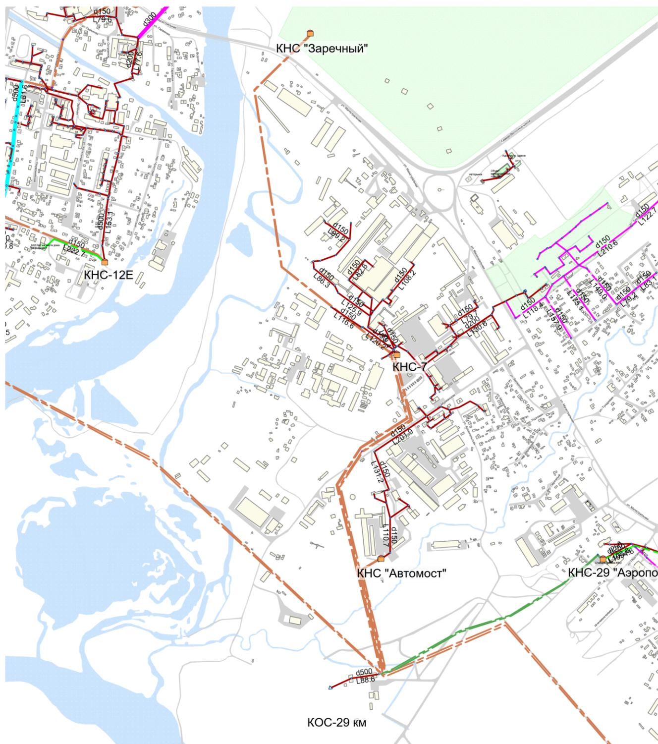
Рисунок 4.39. Расположение КНС «Заречный» и напорного коллектора в модели
