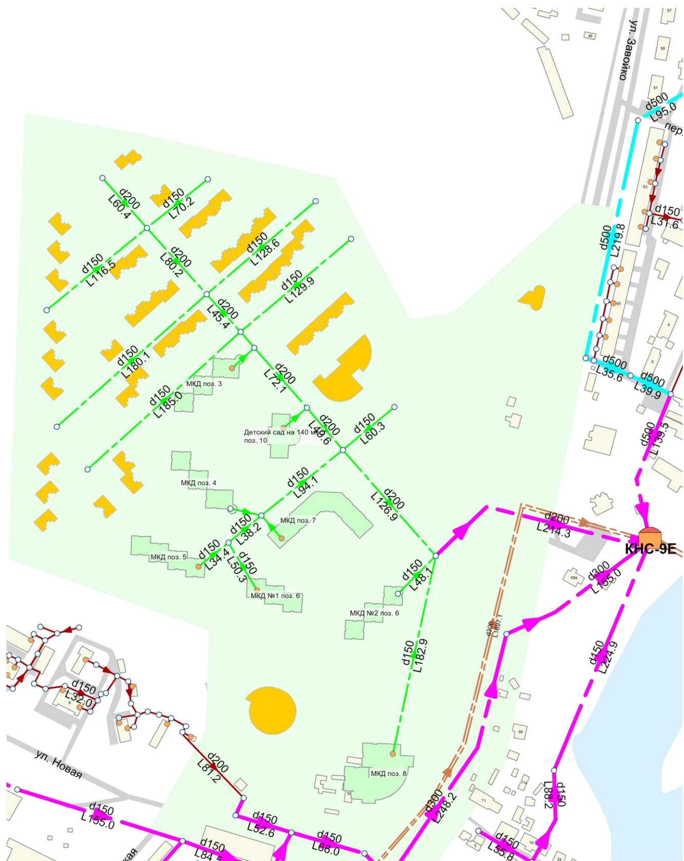
Рисунок 4.13. Подключение объектов МКД поз.3, МКД поз.4, МКД поз.5, МКД №1 поз.6, МКД №2 поз. 6, МКД поз. 7, МКД поз. 8, Детский сад 140 мест поз. 10, а также прочих объектов перспективного строительства мкр. Солнечный
