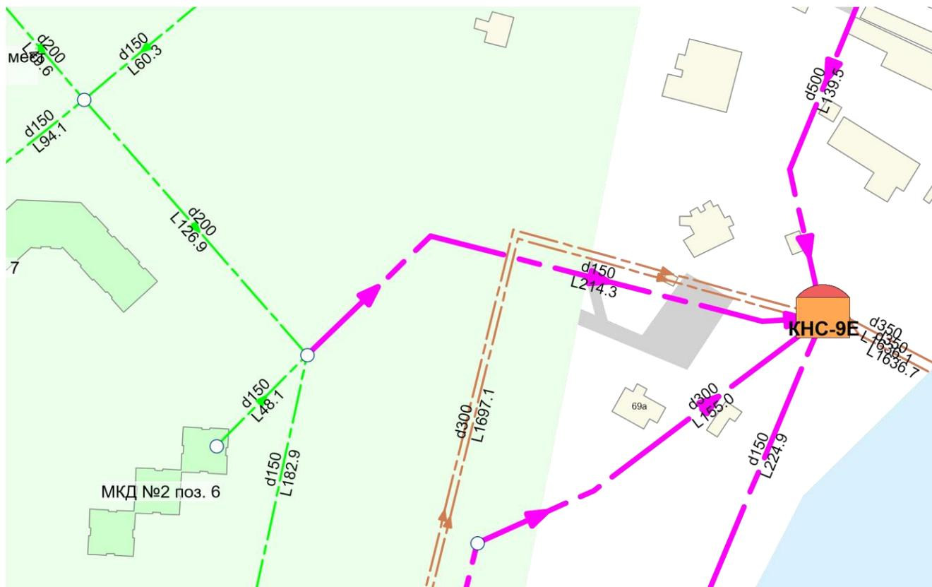
Рисунок 4.12. Строительство самотечного коллектора для подключения территории перспективного строительства мкр. Солнечный
