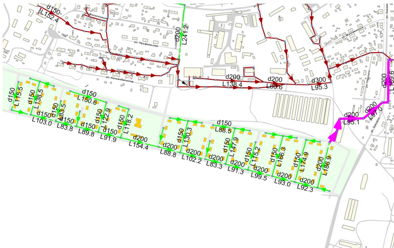
Рисунок 4.26. Подключение к централизованной системе водоотведения перспективной застройки ИЖС по ул. Автомобилистов
