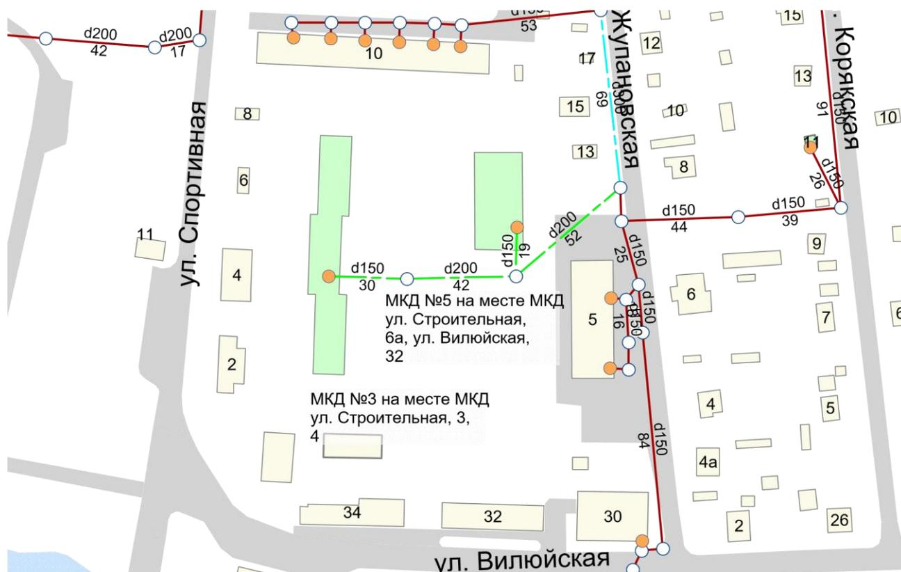
Рисунок 4.5. Строительство сетей водоотведения для подключения объектов МКД №3 на месте МКД ул. Строительная, 3, 4. ЗУ 41:05:0101001:10405, МКД №5 на месте МКД ул. Строительная, 6а, ул. Вилюйская, 32. ЗУ 41:05:0101001:11331
