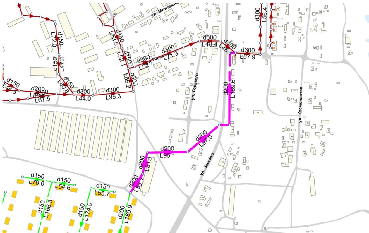
Рисунок 4.25. Строительство самотечного коллектора для подключения к централизованной системе водоотведения перспективной застройки ИЖС по ул. Автомобилистов. Ду 200 мм, протяженность 600 м
