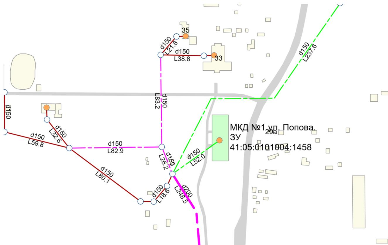
Рисунок 4.22. Строительство сетей водоотведения для подключения МКД №1 ул. Попова. ЗУ 41:05:0101004:1458
