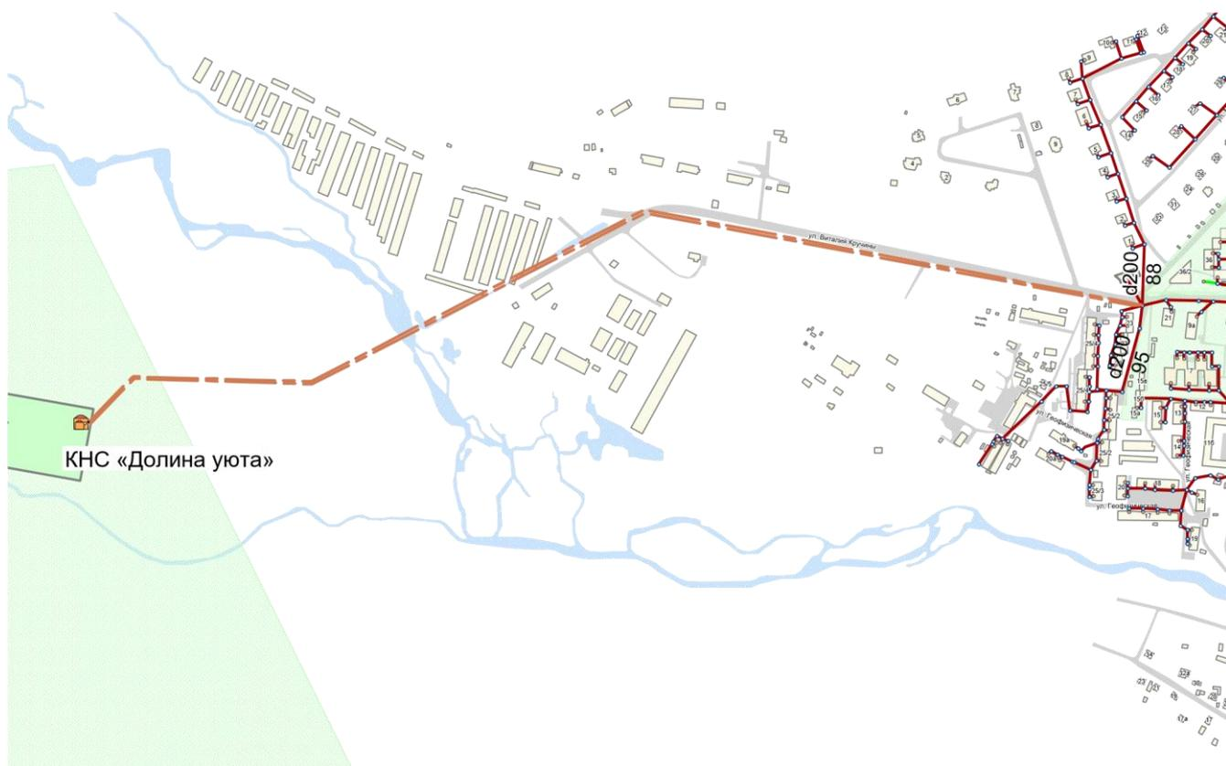
Рисунок 4.35. Строительство КНС «Долина уюта», а также напорного коллектора до камеры гашения напора по ул. В. Кручины.
