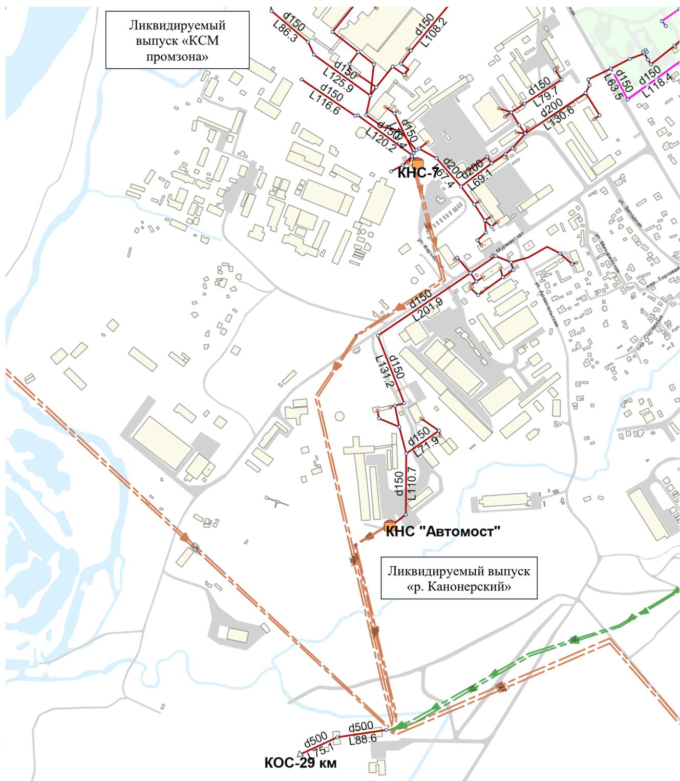
Рисунок 4.40. Расположение КНС-7, КНС «Автомост» и напорных коллекторов до приемной камеры КОС-29 км в модели
