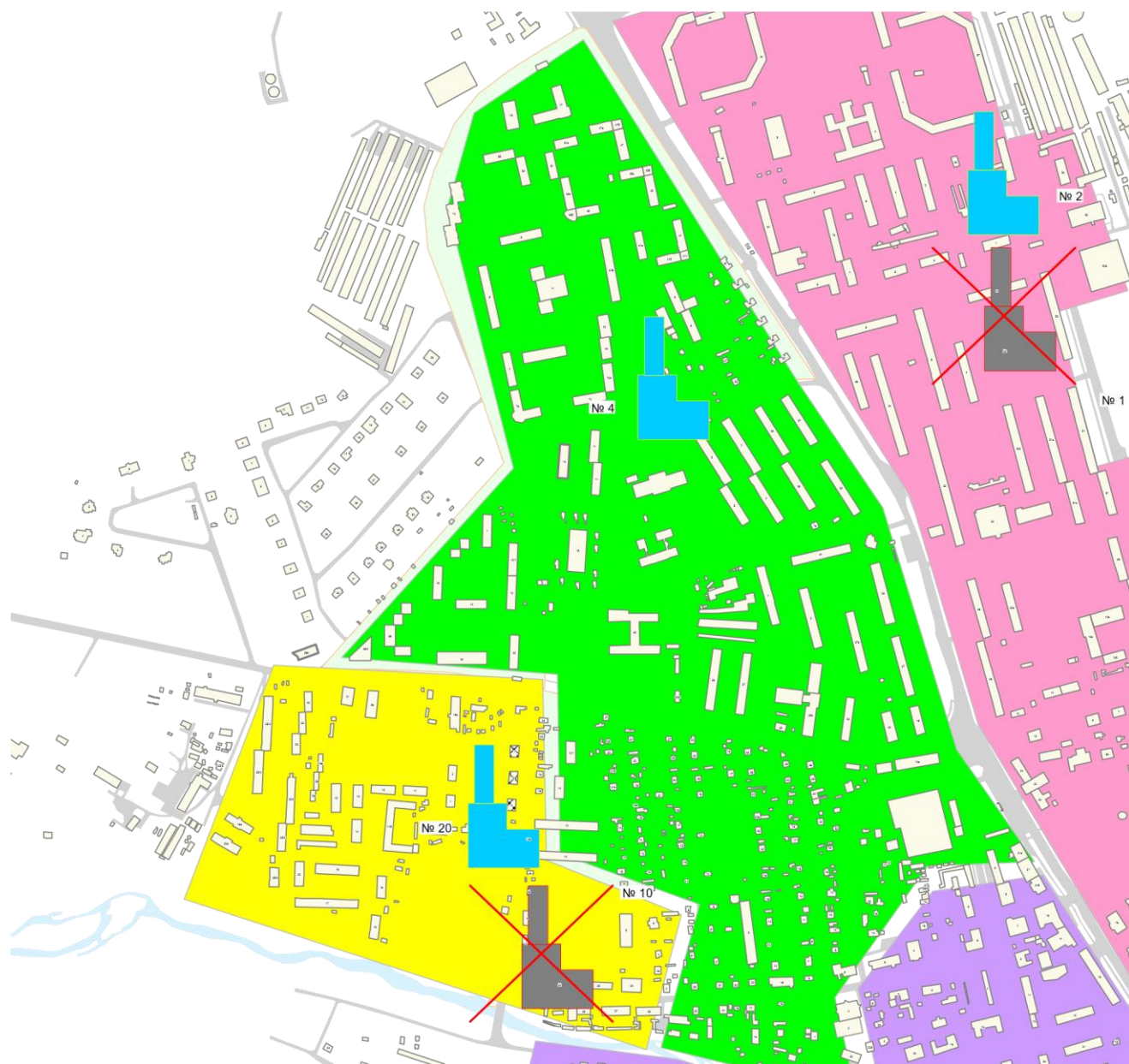
Рисунок 4.2. Зона действия котельной № 4
