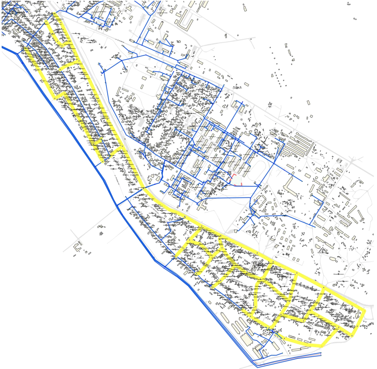
Рисунок 7.20. Новое строительство сетей водоснабжения мкр. Южный
