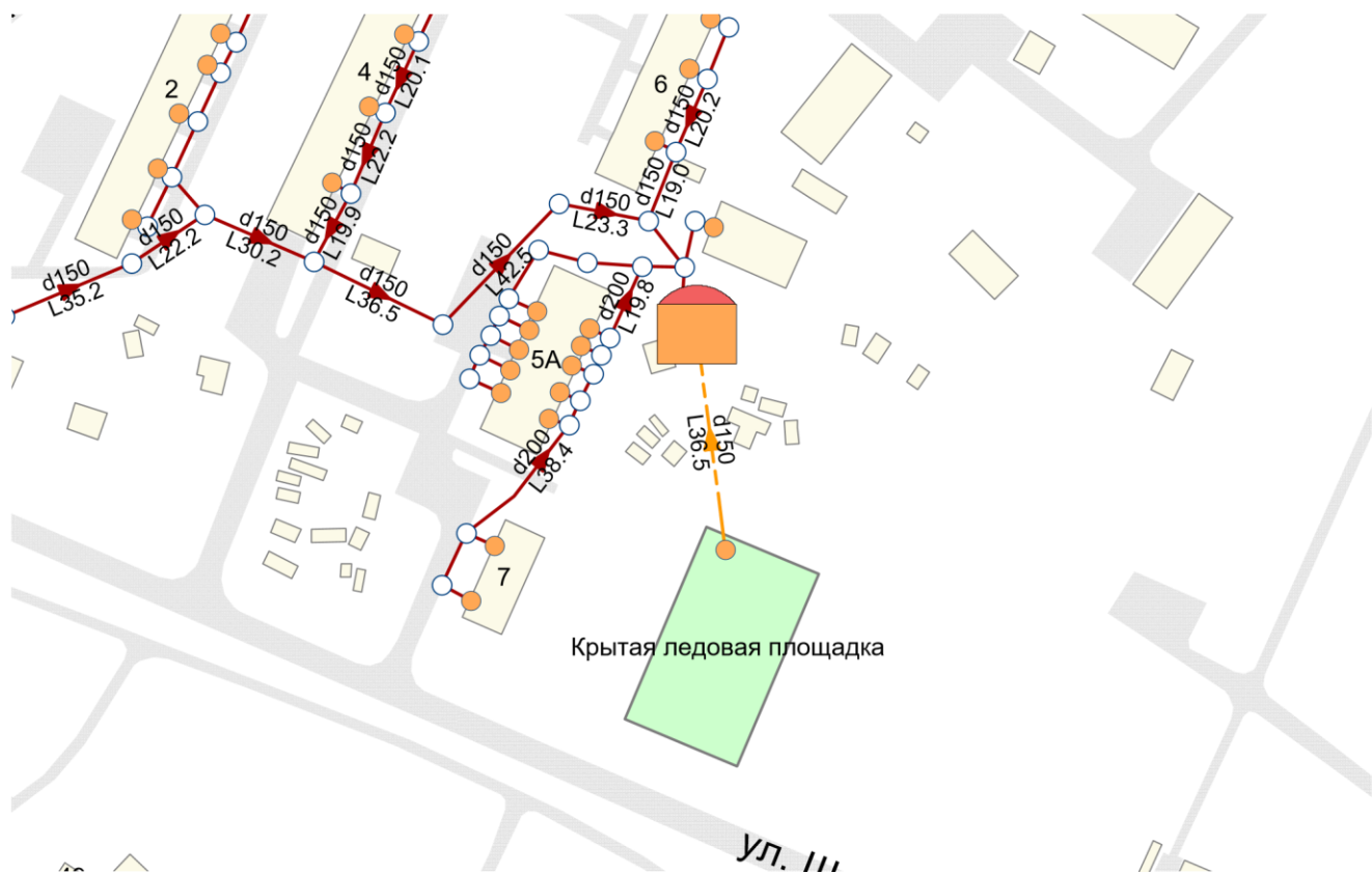
Рисунок 4.16. Подключение крытой ледовой площадки
