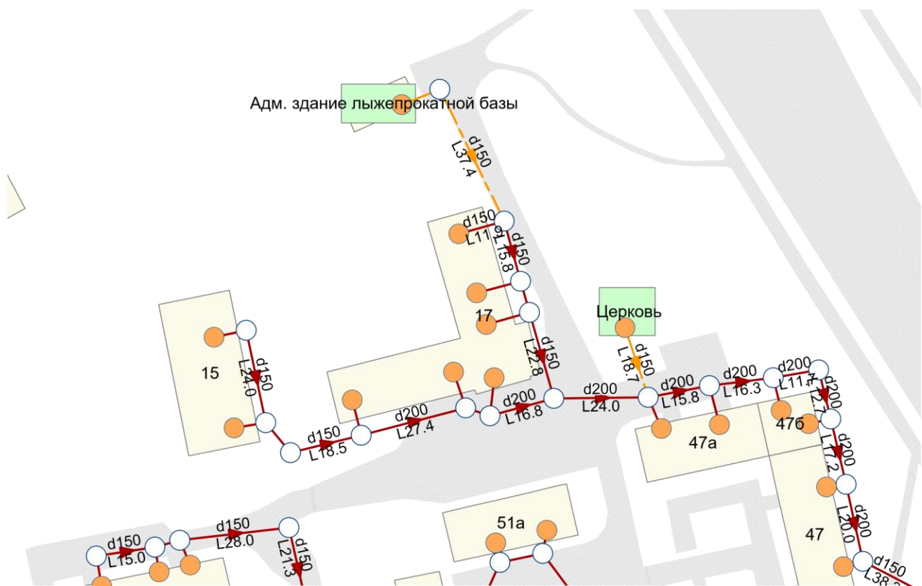
Рисунок 4.17. Строительство сетей водоотведения для подключения объектов «Административное здание лыжепрокатной базы», «Церковь ул. Ленина».
