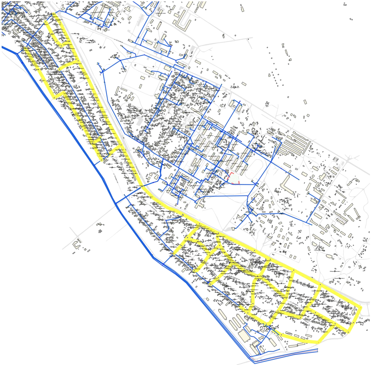
Рисунок 7.20. Новое строительство сетей водоснабжения мкр. Южный
